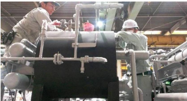
↑ 冷蔵冷凍機全景。メーカー内作業。-40℃製造冷凍機 ↓ 断熱作業5人くらいで取りかかる。この工期5~6日。
