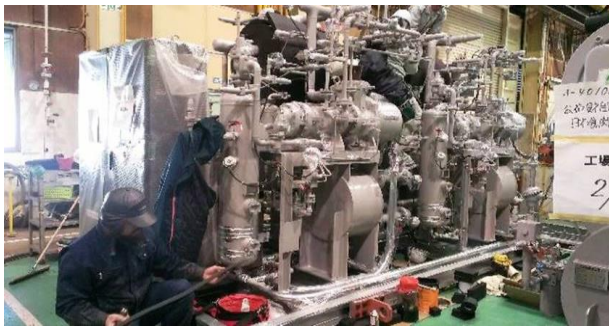
↑ 冷蔵冷凍機全景。メーカー内作業。-40℃製造冷凍機 ↓ 断熱作業5人くらいで取りかかる。この工期5~6日。
