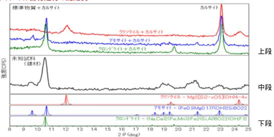
中段のデータは、建材試料の測定結果です。上段はカルサイト(炭酸カルシウム)に3種類の石綿標準試料(クリソタイル、アモサイト、クロシドライト)を5%ずつ混合した試料例で、下段はデータベースに登録されている各標準試料のデータです。これらから、中段の建材中には、多量のアモサイトが含まれていることがわかります。
