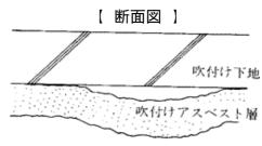
局部的損傷·欠損 人為的·経年変化によって生じた局部的な凹凸、は〈落、は〈離。
