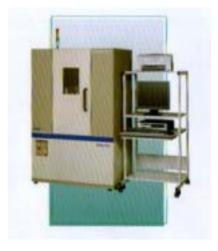
\*本装置は労働基準局長通達 基発第0622001号(H17.6.22) に準拠したX線回析測定が可能です。
