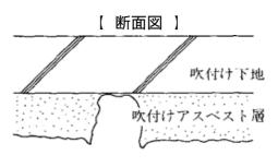
層の損傷·欠損 人為的·経年変化によって生じた全面的な凹凸、は〈落、は〈離。
